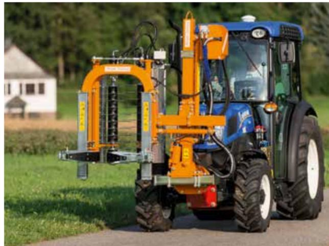
La VSL 07 P est la plus légère des prétailleuses Binger. Des disques de coupe rotatifs tournant en sens contraire coupent la vigne sur la hauteur souhaitée. L'absence de cages de protection permet de tailler avant la chute du feuillage sans risque de bourrage. Chacun des deux arbres sur lesquels sont empilés les disques est entraîné par un moteur distinct. Les modules de coupe s'écartent d'une simple pression sur un bouton lors de l'entrée dans la rangée ainsi qu'au passage des piquets.
