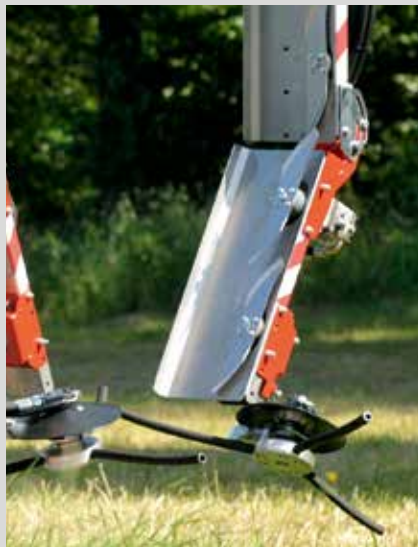
Triebheber an Unterschnittmesser mit zwei Messern
