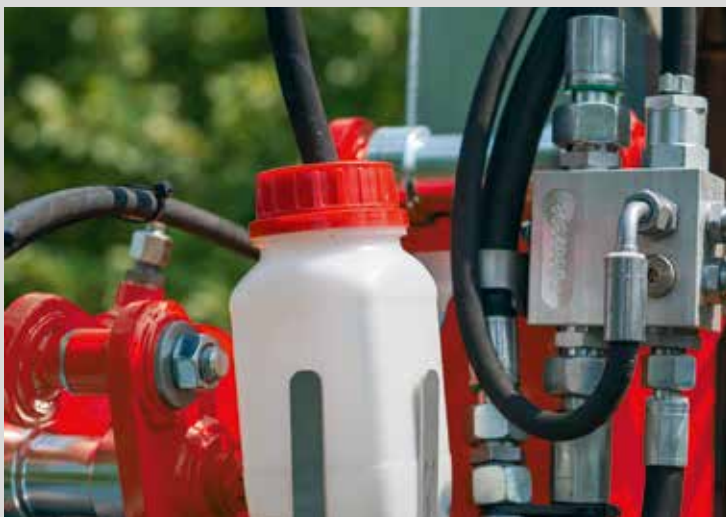
6-Bar-DBV, schützt den Antriebsmotor des Laubschneiders vor Beschädigung durch Druckspitzen im Rücklauf. Bietet Schutz auch bei Bedienungs- und Anwendungsfehlern.
