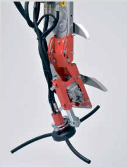
Triebheber an Unterschnittmesser mit einem Messer
