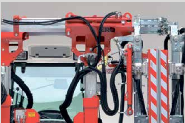
Hydraulische Seitenverschiebung (40 cm)
