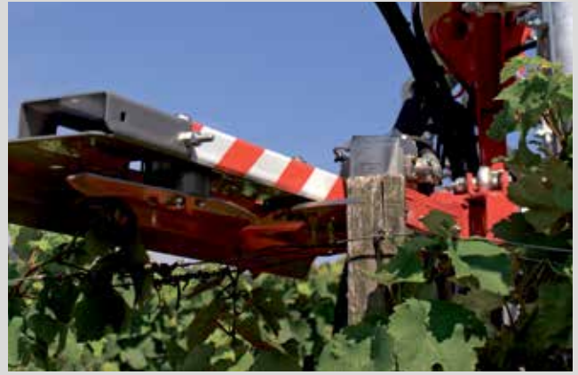
Anfahrssicherung waagerechter und senkrechter Schneidbalken über Gasfeder mit selbsttätiger Rückstellung
