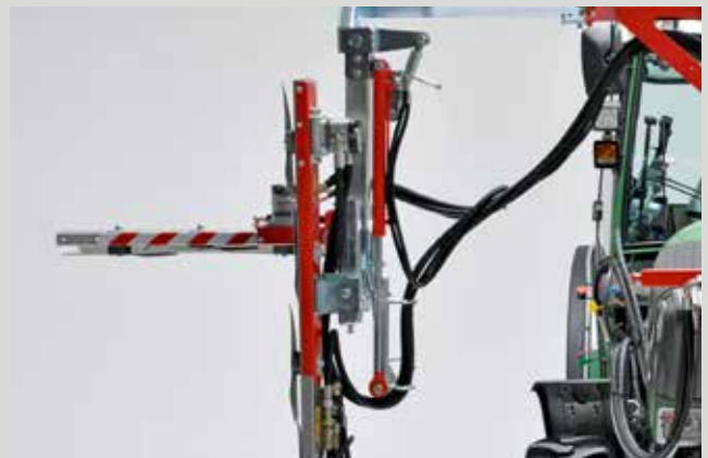
Hydraulische Schnitthöhenverstellung des waagerechten Schneidbalkens (40 cm)
