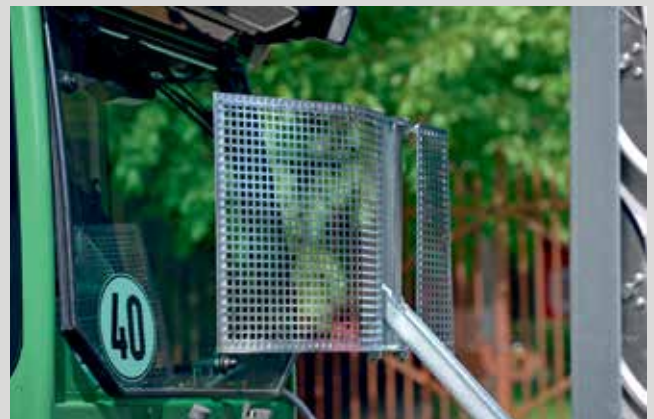
Schnittschutz für Laubschneider mit Boogie
